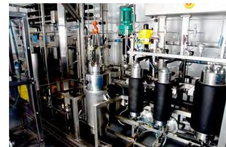
Unité Pilote CO2 (réacteur et colonne de fractionnement)
