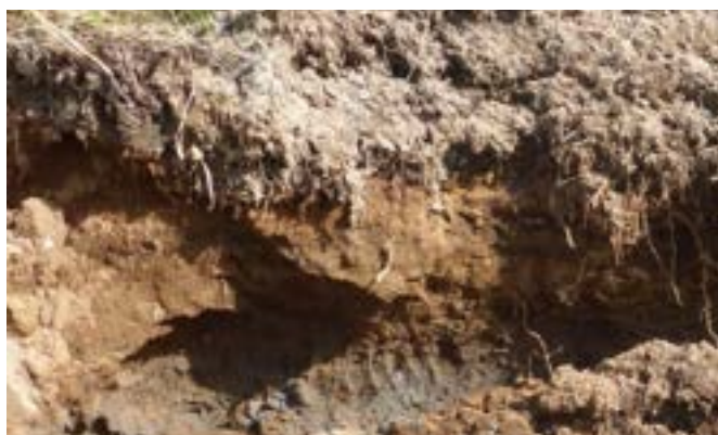
Sable compact : le sol se défait en gros morceaux angulaires et les racines n'arrivent pas à traverses l'horizon de sol compact
